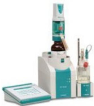
Автоматический кулонометрический титратор 851 Titrando является многофункциональным прибором. С помощью этого титратора можно определять воду в диапазоне от 0,001 до 1%. Титратор 851 Titrando предлагает широкие возможности титрования по КФ:
